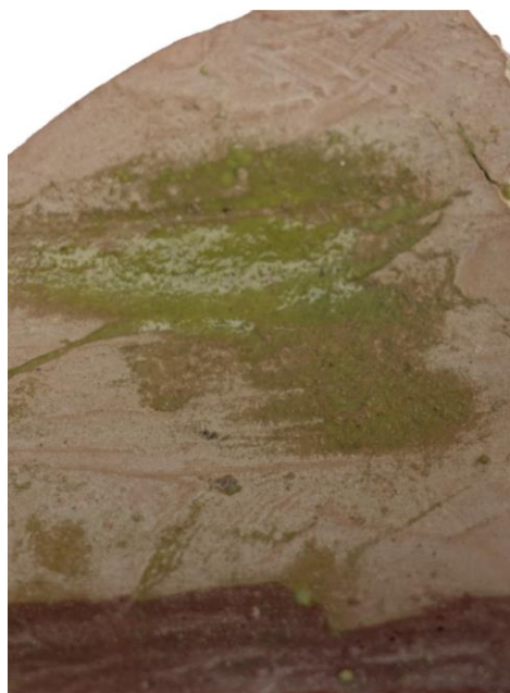
Fig. 7. Deteriorarea glazurii în urma depășirii temperaturii de 900°C (experiment).
