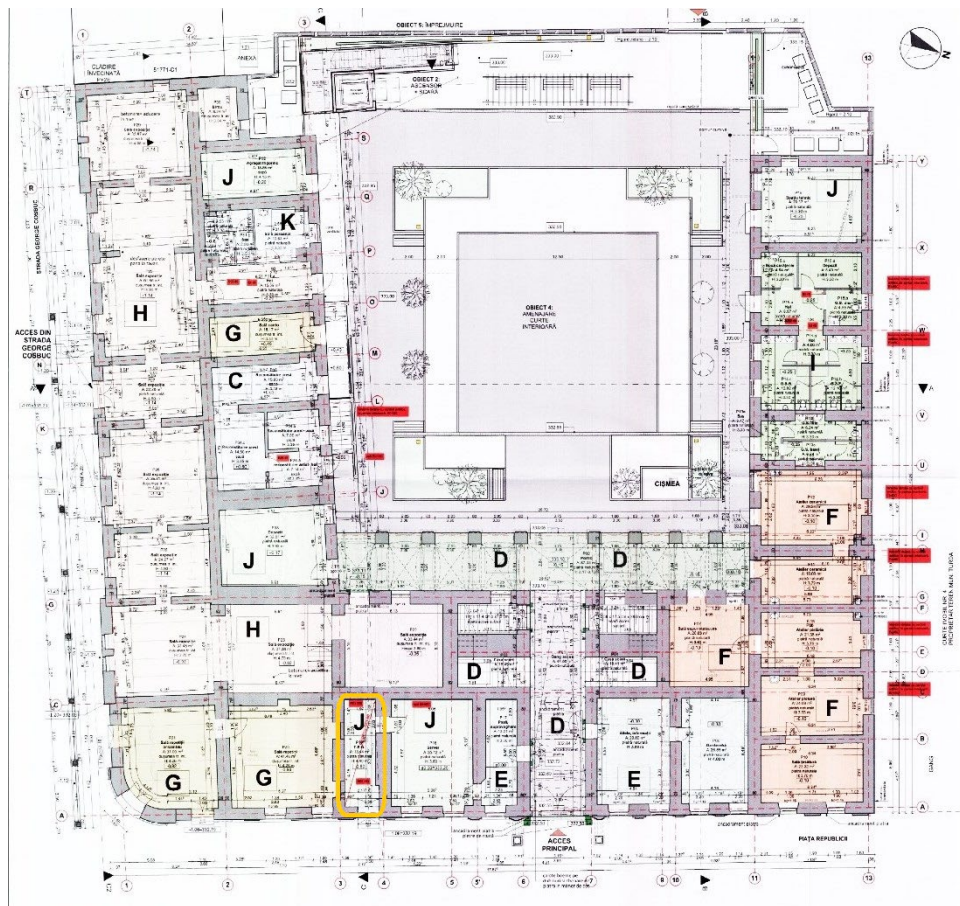
Fig. 3 – Releveu al suprafeței parterului, Axul 3-4, sala P19, Centralizator funcțiuni / suprafețe parter, secțiunea J - Spații tehnice
