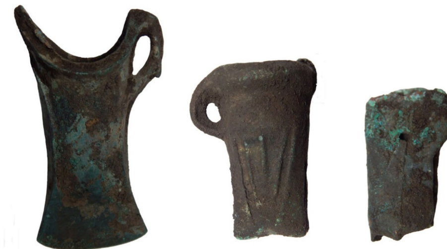
Fig. 2. Depuneri aderente de pământ și produși de corозиune ai cuprului, depozite verzi de săruri și oxizi brun-roșcați pe toată suprafața
