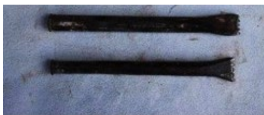
Fig. 24. Gradine cu dinți fini.
