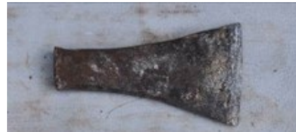
Fig. 29. Daltă lată pentru îndreptarea unei suprafețe.
