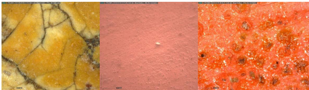
Fig. X7 – Cracluri și alterarea culorii; Fig. X8 – Saponificare și formare de micro-cratere
