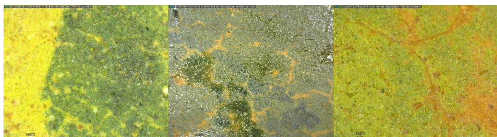
Fig. X5 – Imaginile microscopice (225X) ale zonelor pictate cu verde în care se observă prezența pigmentului albastru
