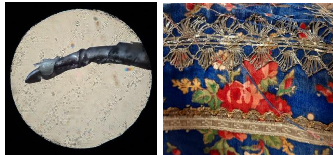
Fig. 8 – Test de ardere pentru mătase (400x)
