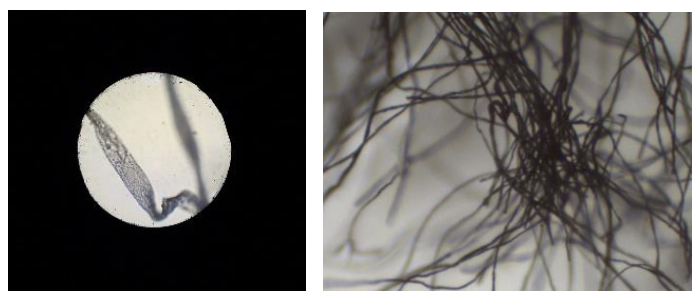
Fig. 7 – Detalii fire metalice (400x, 20x)
