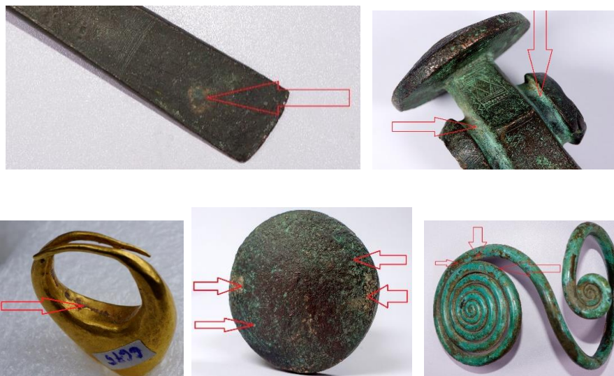
Fig. 4 - Degradări apărute în perioada în care obiectele au devenit bunuri culturale din cadrul patrimoniului muzeal: apariția unor atacuri chimice (procese de coroziune) sub forma a diferite pete de culoare, desprinderi ale straturilor superioare
